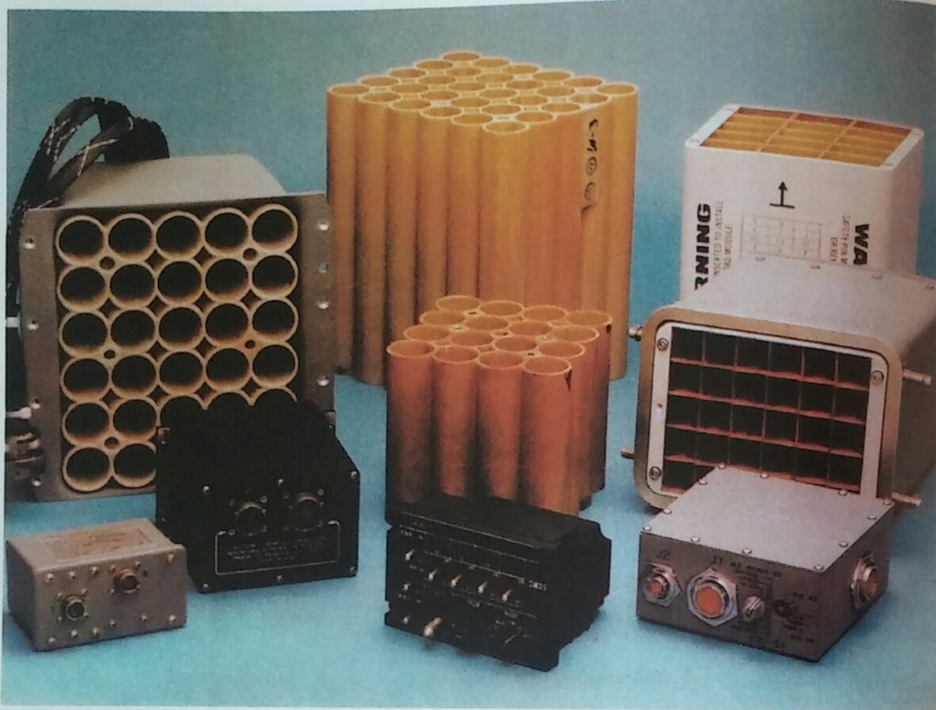
(Επάνω) Το σύστημα ALE-47 της Tracor. Οι μονάδες με τις κυκλικές οπές είναι σχεδιασμένες για το Ναυτικό, ενώ οι μονάδες με τις τετράγωνες οπές είναι σχεδιασμένες για την αεροπορία. (Δεξιά) Το σύστημα SAWS (Silent Attack Warning System) της Loral ανήκει στην κατηγορία των παθητικών συστημάτων υπέρυθρου.
